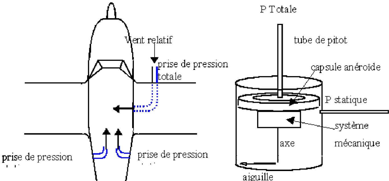
Il mesure un écart entre la **pression totale** de l'air en avant de l'avion (**tube de pitot** ou antenne anémométrique) et la **pression statique** mesurée sur les **prises de pression statique**. Une capsule anéroïde vidée d'air se déforme plus ou moins en fonction de cet écart, et un dispositif mécanique relié à cette capsule fait tourner l'aiguille indicatrice.
