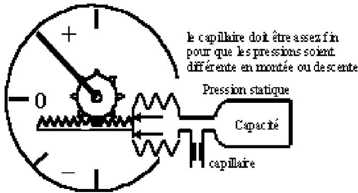
La capsule du variomètre est reliée à un réservoir et est mise à l'air libre à l'aide d'un capillaire calibré, ce qui entraîne un retard à l'indication ( retard à l'établissement de l'équilibre de pression ). Cet instrument indique alors la différence de pression entre un instant t et l'instant précédent
