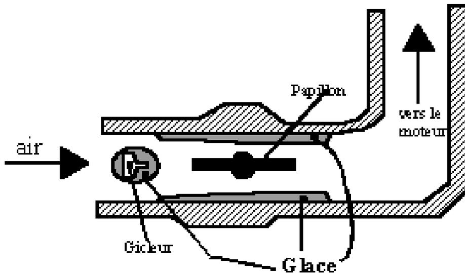
Il s'agit d'un phénomène dangereux en aviation légère, en effet le givrage de l'intérieur du carburateur arrête l'arrivée de carburant au moteur.
