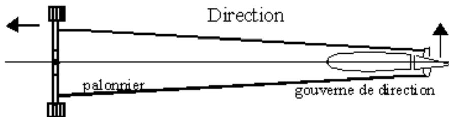
Une action à pousser au pied droit entraîne la gouverne de direction vers la droite et engage un virage plat à droite. Les deux palonniers sont liés mécaniquement, lorsque le pied droit avance, le pied gauche recule.
