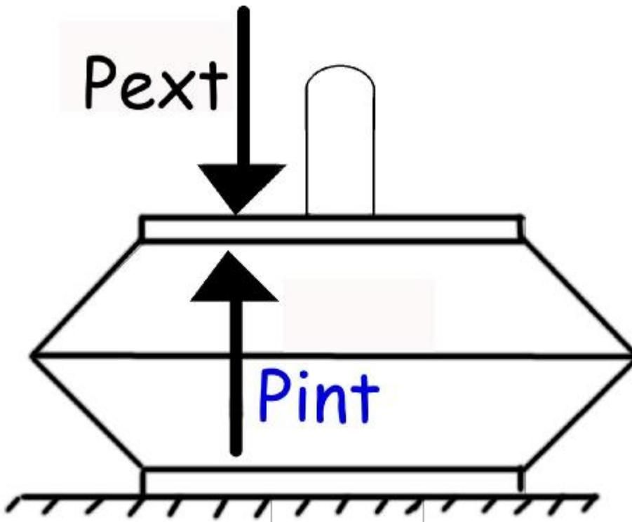
Il s'agit d'un ensemble fermé et sellé en usine sous atmosphère standard (1013,25 hPa à 15° C).
