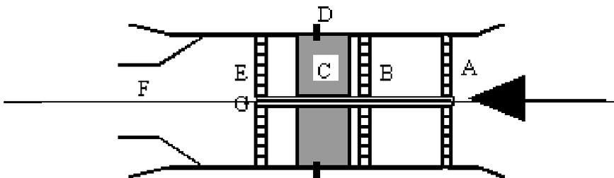
L'air est aspiré par l'ensemble de pales tournantes A, puis comprimé par l'ensemble tournant B. Au point D est injecté le carburant (en général du *Kérosène*) dans la chambre de combustion C. L'étincelle permettant la combustion est produite également au point C.
