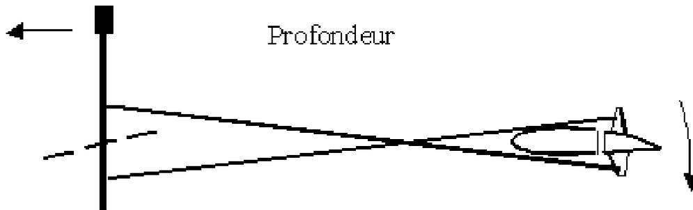
Une action en profondeur sur l'axe de tangage vers l'avant (manche en avant) entraîne une rotation autour de l'axe du manche et une traction sur le câble supérieur (manche) et inférieur au niveau gouverne de profondeur. Celui ci met alors l'avion en piqué, de même dans l'autre sens à cabrer.
