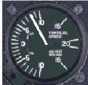
**ATTENTION**, cet instrument possédant un retard à l'indication ne doit pas être considéré comme un instrument de pilotage mais seulement comme un instrument de tendance ( le maintien d'altitude en vol en palier doit être vérifiée à l'altimètre et non au variomètre)
